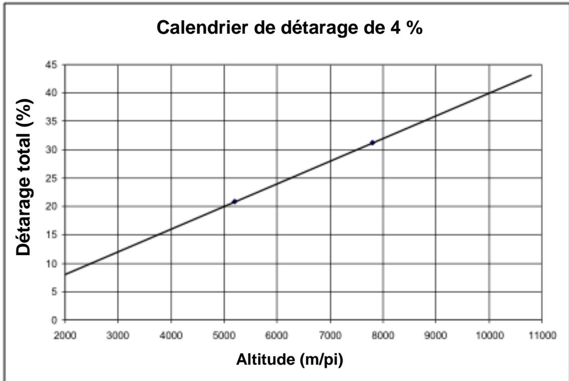
Bien que la capacité de l'appareil est réduite à la densité plus faible de l'air, le réglage de la combustion devrait respecter les directives standards de [3.11](#). Régler la combustion selon les mêmes niveaux de O<sub>2</sub> et CO<sub>2</sub> comme abordé dans [3.11.2](#).
