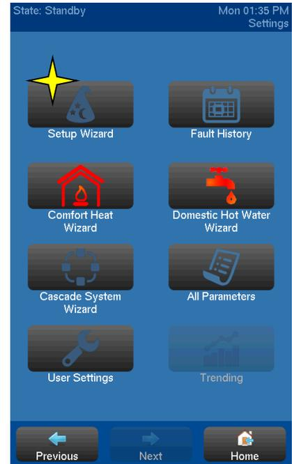
Setup Wizard (assistant intelligent pour la configuration) permet à l'utilisateur d'attribuer des fonctionnalités aux relais A à D configurables par l'utilisateur. Cela permet à l'utilisateur d'attribuer des fonctions comme « Boiler Pump » (pompe de la chaudière), « System Pump » (pompe du système), « Flame Detected » (flamme détectée) et « Air Damper » (clapet d'air de combustion) aux relais.
