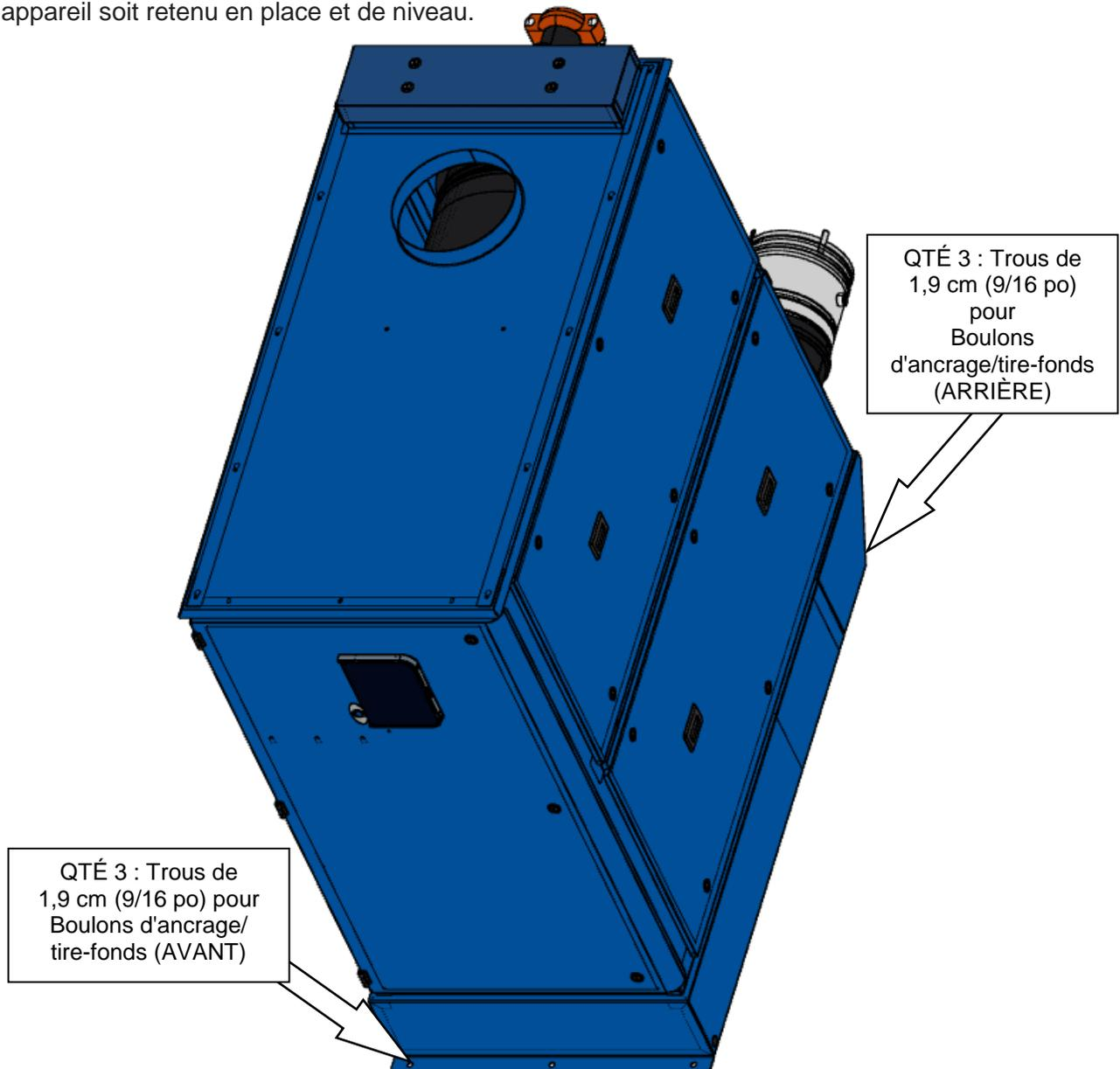
**AVIS!** L'appareil peut être installé sur un sol constitué en matériaux combustibles; toutefois, l'appareil ne doit **JAMAIS** être installé sur du tapis.
